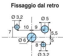
Fissaggio dal retro Rear fixing
